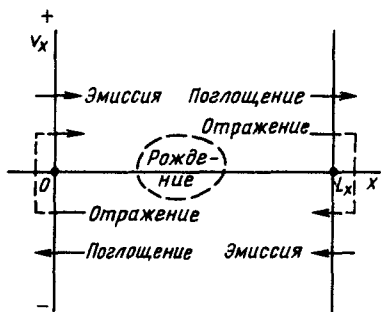
Рис. 16.12. Возможные граничные условия на частицы в фазовом пространстве одномерной продольно ограниченной плазмы
